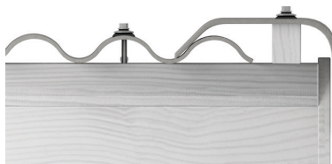
Joonis 40. Painutatud servaga tuulelaua paigaldamine.
