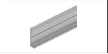
Swisspearl Plank Connecti alustusprofiil, vertikaalne paigaldus Ekstrudeeritud alumiinium Paksus 1,1 mm Pikkus 3000 mm
