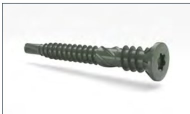
Swisspearl Universal 38, puidukruvi SRC-W 3.9x38 mm Peitkinnitusteks puitkarkassidel
